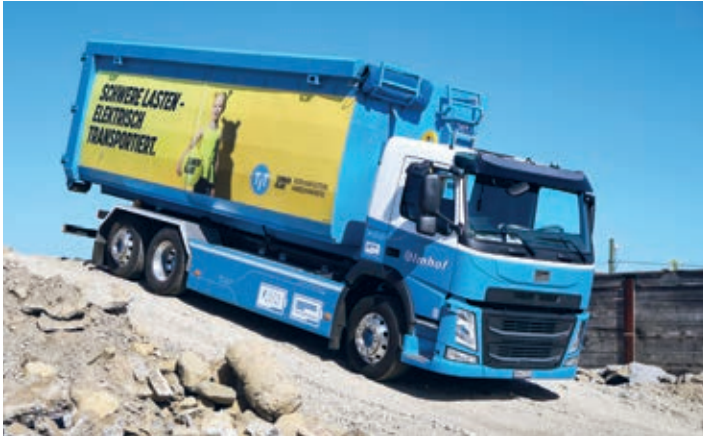
Der elektrisch betriebene Hakenabrollkipper.
